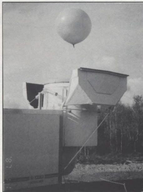
DÅ: Tidigare sköttes uppsändandet av väderballonger manuellt och då kunde det också hänga en radarreflektor under den. NU: Väderballonger släpps idag upp med sk autosond, vilket innebär att den containerliknande automatstationen sköter hela proceduren (bilden).
